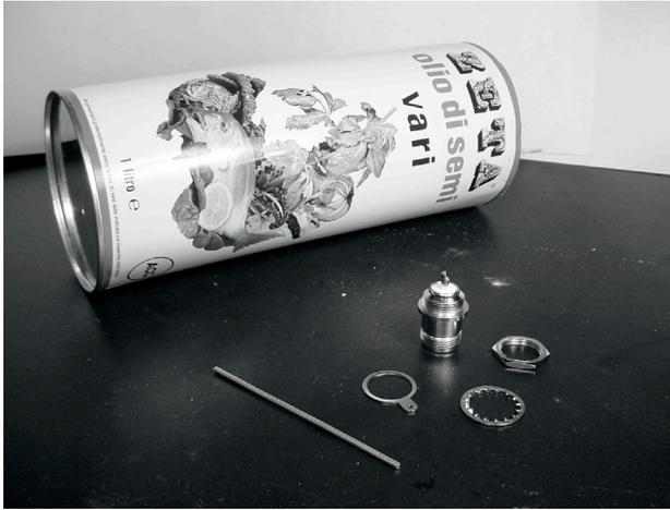
Figura 4.34: Componentes necesarios para la antena de lata.
