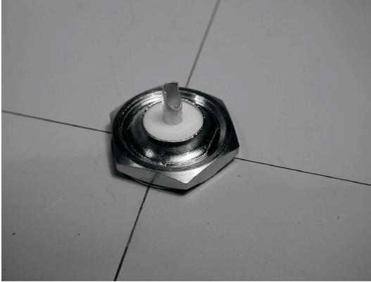
*Figura 4.25: Asegure el conector N firmemente a la placa*
