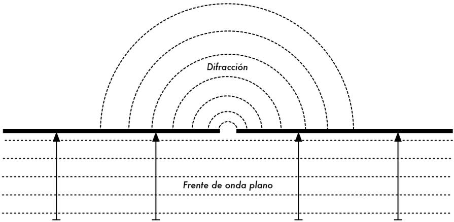
Figura 2.6: Difracción a través de una ranura pequeña.
