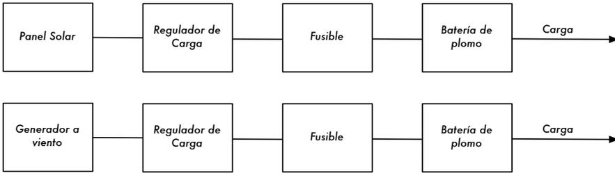
Figura 7.8: Sistema alimentado con energía eólica o solar.
