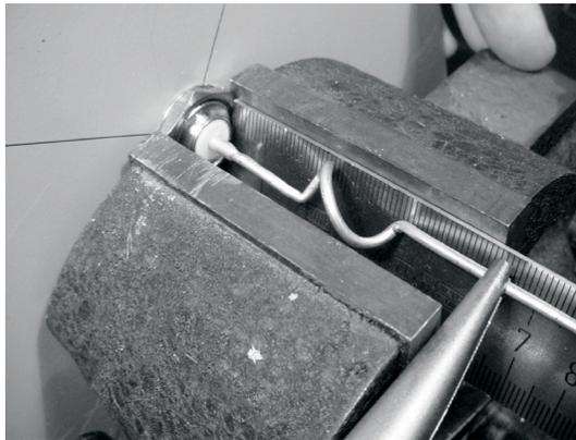
*Figura 4.28: Estirar los anillos. Sea muy cuidadoso y trate de no raspar la superficie del alambre con las pinzas.*
