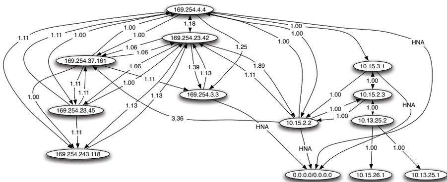
Figura 3.8: Una topología de red OLSR generada automáticamente.
