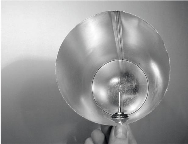
Figura 4.42: Su antena guía-onda terminada
