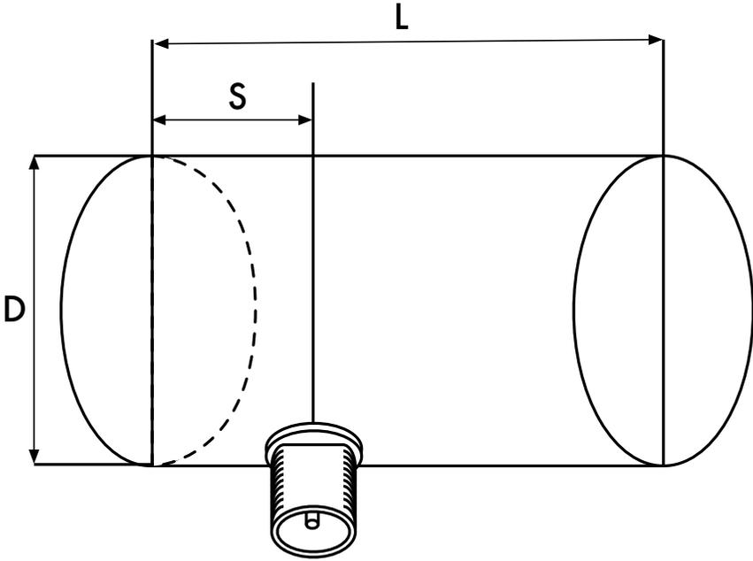
Figura 4.32: Limitaciones de dimensión en la antena guía-onda.
