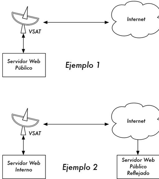
*Figura 8.1: En el ejemplo 1, todo el tráfico del sitio web que viene desde Internet debe atravesar el VSAT. En el ejemplo 2, el sitio web público es alojado en un servicio europeo rápido, mientras que en el servidor interno se mantiene una copia para tener un acceso local muy rápido. Esto mejora la conexión del VSAT y reduce los tiempos de carga para los usuarios del sitio web.*
