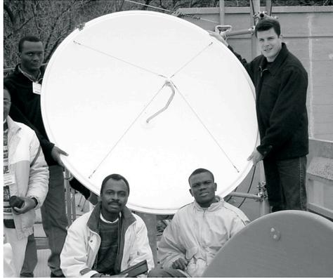
Figura 4.11: Una antena plato sólida.
