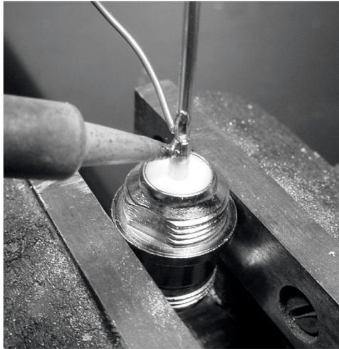
*Figura 4.39: Suelde el alambre a la copa dorada en el conector N.*
