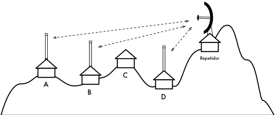
Figura 3.13: El lugar D no puede ver al lugar A o el B, porque el lugar C está en el camino y no está interesado en tener un nodo. Al instalar un repetidor en un lugar alto los nodos A, B, y D se pueden comunicar. El tráfico desde el nodo D en realidad viaja más lejos que el del resto de la red antes de que el repetidor reenvíe esos datos.
