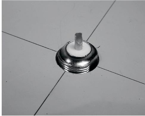
*Figura 4.23: El conector N debe encajar exactamente en la perforación.*
