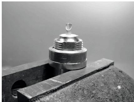
*Figura 4.24: Agregar un tubo de cobre espaciador ayuda a obtener la impedancia de la antena de 50 Ohms.*
