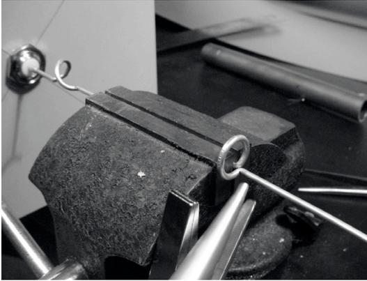
*Figura 4.29: Repita el procedimiento de ajuste para todos los anillos restantes.*
